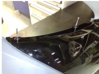
Rivets sur face supérieure
